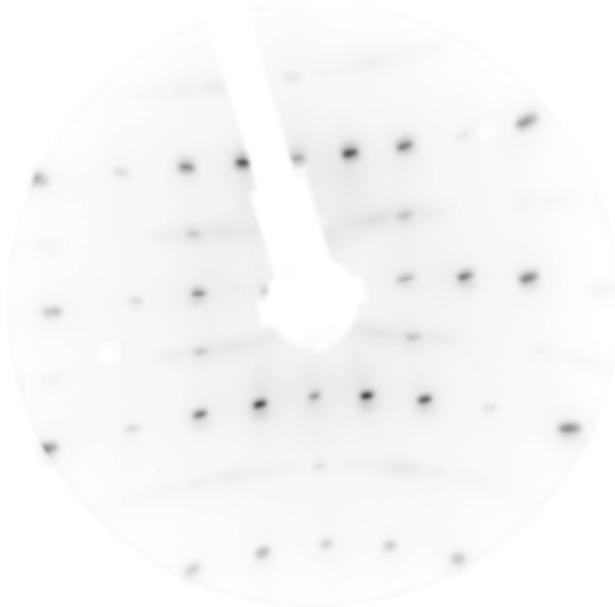
Abbildung 16: Aufnahme mit Si[100] mit Averaging. Die Energie der Aufnahme ist 135eV und es handelt sich um die gleiche Probe wie in Abbildung 15. Zur besseren Sichtbarkeit wurde das LEED-Bild farblich invertiert.
