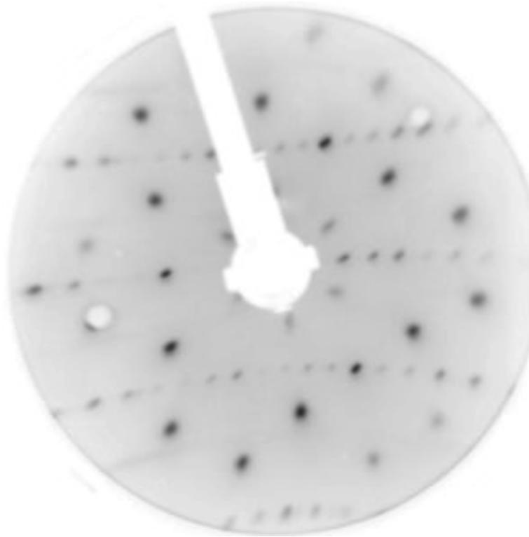
Abbildung 27: LEED-Bild der Si[111]- $\sqrt{3} \times \sqrt{3}$ Au Oberfläche mit der Si(111)-(5x2)-Au Oberfläche mit einer Rotationsdomäne. Zu sehen ist die gemittelte Aufnahme bei einer Energie von 120 eV. Zur besseren Sichtbarkeit wurde das LEED-Bild farblich invertiert und dann um 15% verdunkelt.
