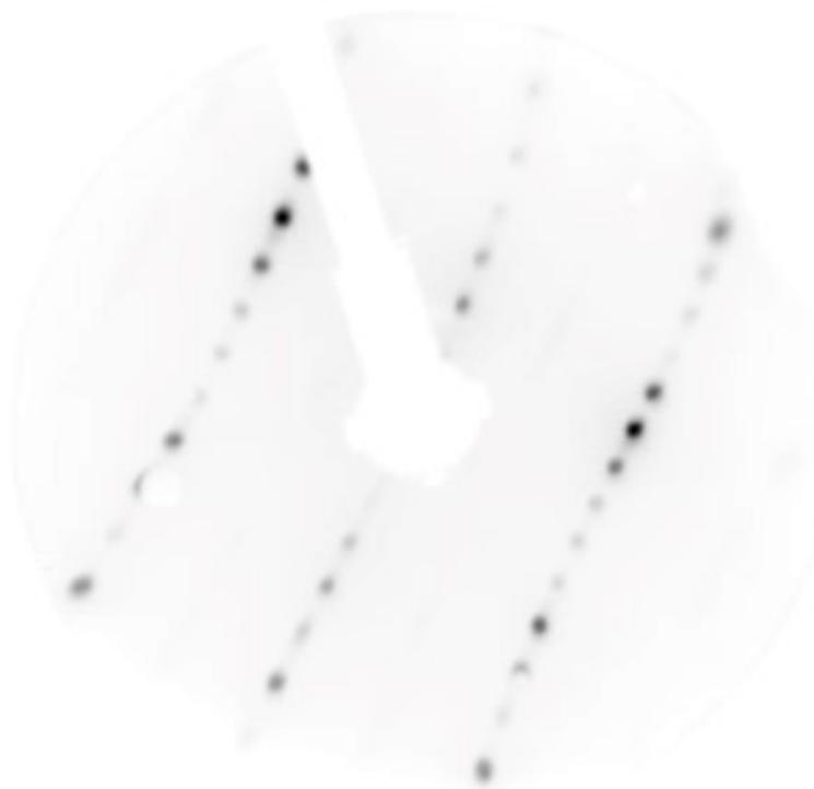
Abbildung 28: LEED-Bild der Si(111)-(5x2)-Au Oberfläche mit einer Rotationsdomäne. Zu sehen ist die gemittelte Aufnahme bei einer Energie von 100 eV. Zur besseren Sichtbarkeit wurde das LEED-Bild farblich invertiert.
