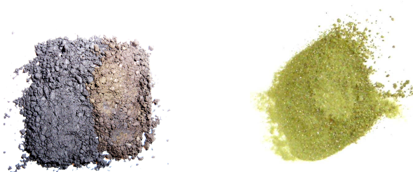
Abbildung 4.7: Farbveränderung des \text{Pr}_6\text{O}_{11} -Pulvers während des Tempens. von links nach rechts: schwarz, unbehandelt; braun-grau, nach Tempern auf einige 100^\circ\text{C} ; grün, Phasenumwandlung zu kubischem \text{Pr}_2\text{O}_3 .
