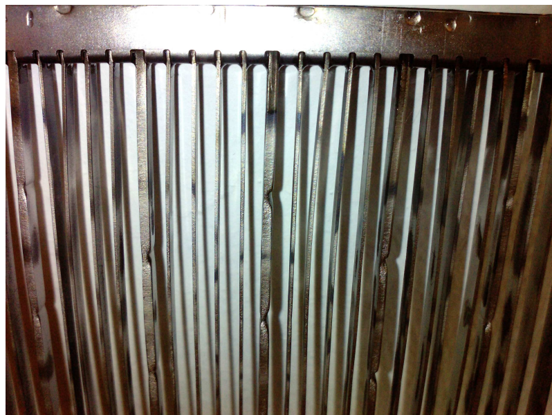
Abbildung A.3: Einseitig verschlissene Titan-Streifen-Kathode.
