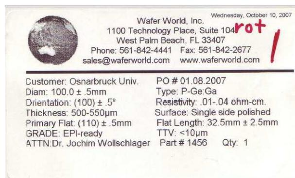
Abbildung 10.11: Herstellerangabe der p-dotierten Germaniumprobe.
