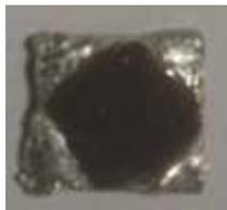
Abbildung 4.1: Germanium mit Indiumkontakten an den Ecken. Die Maße betragen 7mm x 7mm und die Dicke 0,5-0,55mm. Der größte Kontakt besitzt eine Breite von 3mm.
