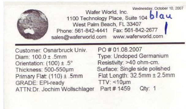
Abbildung 10.9: Herstellerangabe der undotierten Germaniumprobe.
