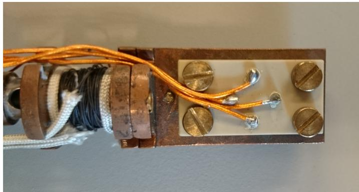
**Abbildung 6.1:** Abbildung des Probenhalters mit den vier Zuleitungen zu den vier Kontakten. Das mit den vier Kontaktspitzen versehene Oberstück kann mit den vier Schrauben fixiert werden.
