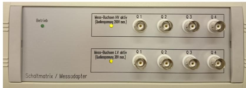
**Abbildung 4.4:** Frontansicht der Schaltmatrix mit den zwei Messbereichen. Der obere Messbereich eignet sich für Spannungen bis maximal 200 V. Der untere bis maximal 38 V. Es sind jeweils vier Anschlüsse Q1 - Q4 vorhanden. Zwei dieser Anschlüsse speisen den konstanten Strom ein, die zwei weiteren Anschlüsse messen die Spannung.
