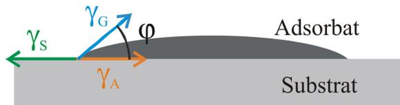
Abbildung 2.16: Schematische Darstellungen der Oberflächenspannungen  $\gamma_S$ ,  $\gamma_A$  und der Grenzflächenspannung  $\gamma_G$ . Bei  $\varphi$  handelt es sich um den Winkel zwischen der Richtung der Grenzflächenspannung und der Oberflächenspannung des Adsorbats.
