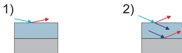
**Abbildung 2.3:** Schematische Darstellung eines einfachen Schichtsystems. In 1) ist der Einfallswinkel kleiner als  $a_c$ , die Strahlung kann nicht in die Schicht eindringen. Es findet Totalreflexion statt. In 2) ist der Winkel größer  $a_c$ , die Strahlung dringt in die Schicht ein und wird von der Grenzfläche zum Substrat reflektiert, es findet eine Überlagerung der reflektierten Strahlen statt.
