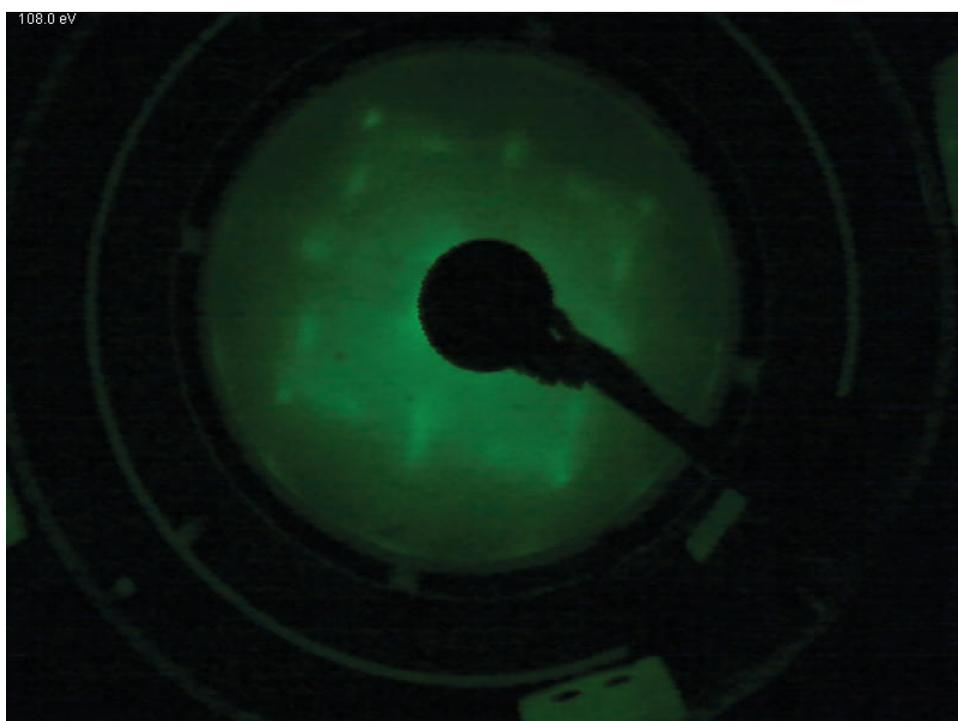
Abbildung 5.29: LEED-Bild der 100Hz-Eisenoxidschicht auf Ag(001) bei  $E = 108eV$
