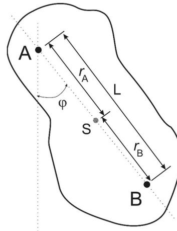
Abbildung 2: Reversionspendel = Physikalisches Pendel mit zwei Aufhängepunkten **A** und **B**, dessen Massenverteilung so verändert werden kann (nicht gezeigt), dass  $T_A = T_B$  gilt. **S** ist der zwischen **A** und **B** liegende Schwerpunkt. Die im Versuch verwendete Bauform wird unten dargestellt.
