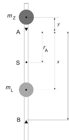
Abbildung 3: Skizze des im Versuch verwendeten Reversionspendels. Die Masse  $m_Z$  ist im Versuch ortsfest,  $m_L$  wird verschoben. Sie werden also im Versuch die Koordinate  $x$  variieren, und damit auch  $r_A$ .  $m_L$  ist kleiner als  $m_Z$ .
