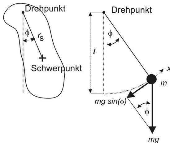
Abbildung 1: Physikalisches Pendel und Fadenpendel oder mathematisches Pendel (Kugel als Punkt auffassen). Rückstellkraft beim Fadenpendel als Projektion der Schwerkraft auf die Kreisbahn. Die krummlinige Koordinate  $x$  ist über die Pendellänge  $l$  mit dem Winkel  $\Phi$  verknüpft. Man kann die gleiche Rückstellkraft für den Schwerpunkt des physikalischen Pendels verwenden.
