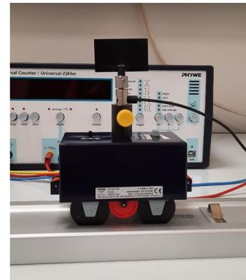
Abbildung 4: Messwagen mit Detektor und Messscheibe.
