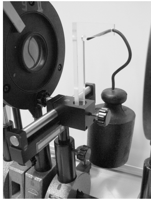
Abbildung 12: Plexiglaswinkel mit Biegegewicht. Nur ein kleiner Teil des Winkels wird beleuchtet.
