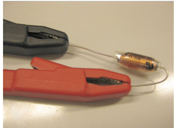
Abbildung 8: Mit Krokodilklemmen kontaktierte kleine Spule.
