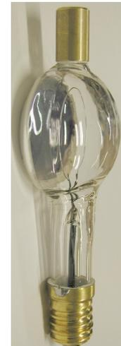
Abbildung 2: Bild der Photozelle. Silbergraue Kathode, mit Messinghülse oben verbunden. Ringförmiger Pt-Draht mit Schraubsockel verbunden.
